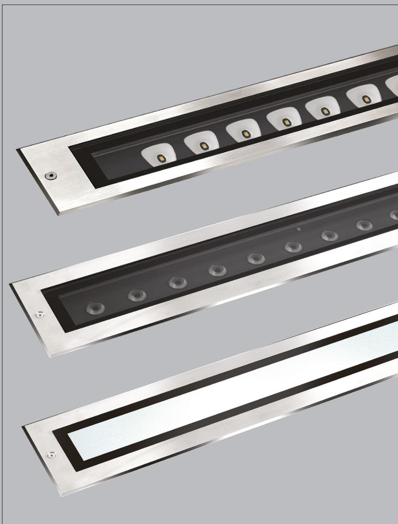
Linea di apparecchi da incassare a terreno, progettati in lega in alluminio estruso (EN AW 6060 T5) ad alta resistenza alla ossidazione e sottoposto a trattamento di nanoceramico bonderite che, con la verniciatura a polvere poliestere, garantisce al prodotto alta resistenza agli agenti atmosferici, ai raggi UV e assicurandone massima protezione nel tempo.
