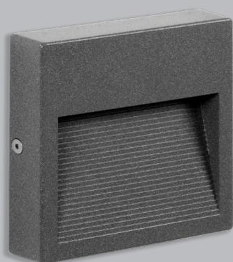
Linea di apparecchi di illuminazione a parete in lega in alluminio (EN AB 44100) ad alta resistenza alla ossidazione e sottoposto a trattamento di nanoceramico bonderite che, con la verniciatura a polvere poliestere, garantisce al prodotto alta resistenza agli agenti atmosferici, ai raggi UV e assicura massima protezione nel tempo.
