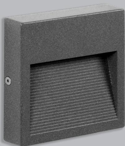
Linea di apparecchi di illuminazione a parete in lega in alluminio (EN AB 44100) ad alta resistenza alla ossidazione e sottoposto a trattamento di nanoceramico bonderite che, con la verniciatura a polvere poliestere, garantisce al prodotto alta resistenza agli agenti atmosferici, ai raggi UV e assicura massima protezione nel tempo.
