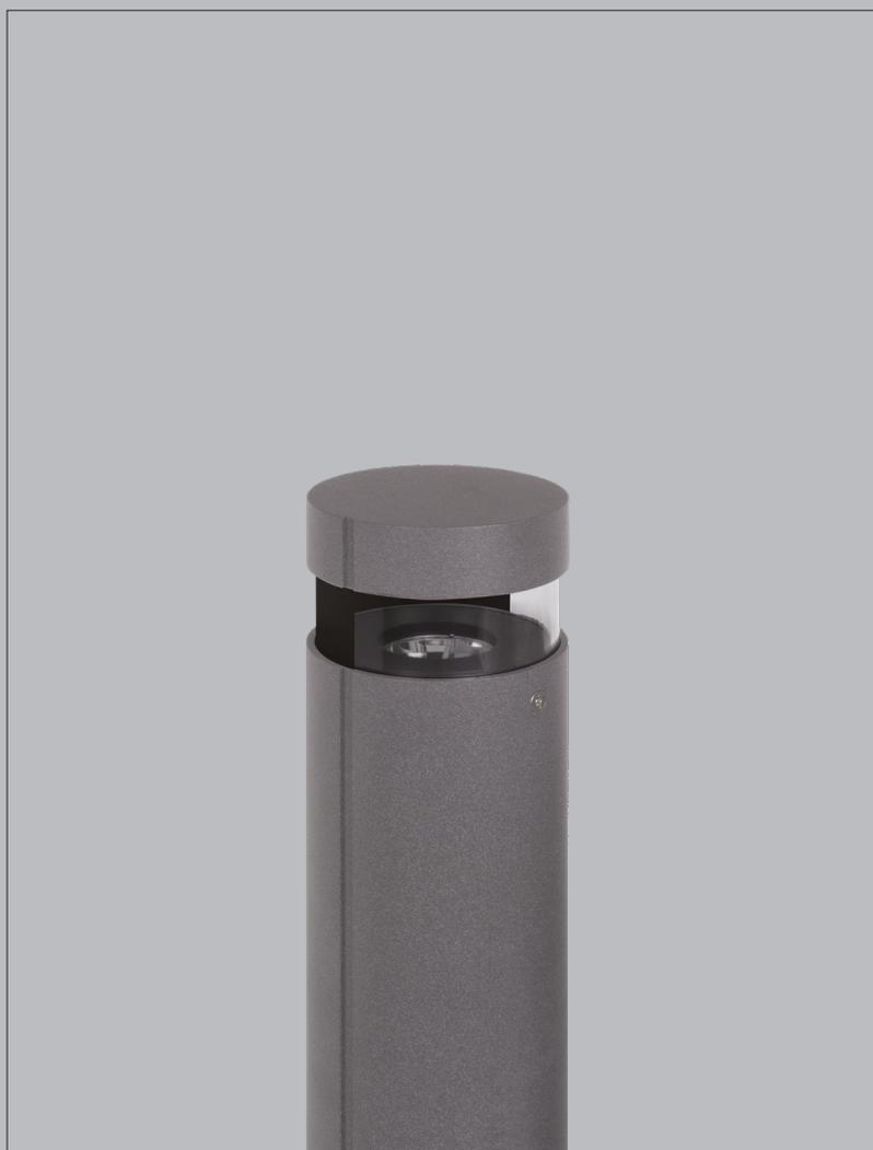
Linea di bollard realizzati in alluminio estruso con emissione di luce direzionata a 180° e 360°. particolarmente dinicato per l'illuminazione di camminamenti, viali, parchi, giardini.
