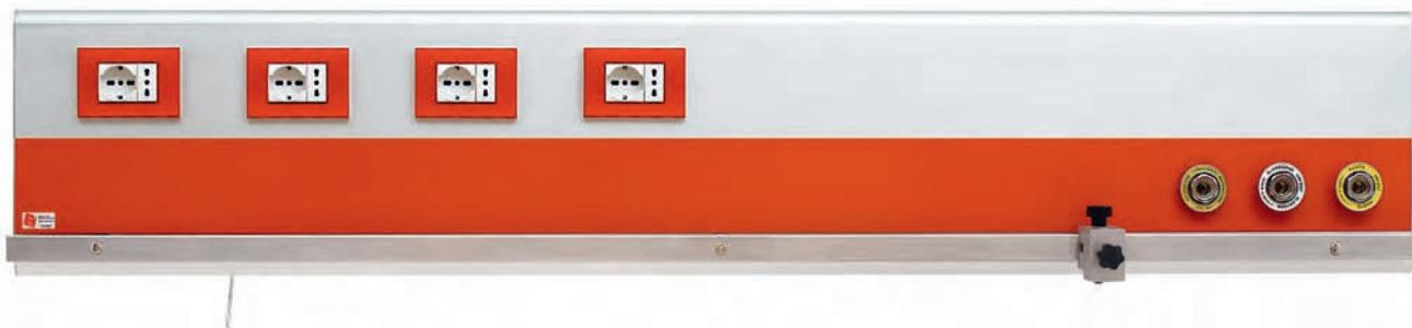
Due profili in estruso di alluminio, separati tra loro e chiusi da supporti frontali fissati a scatto e senza viti, sui quali alloggiavano i frutti elettrici e le prese gas, compongono questo dispositivo.
