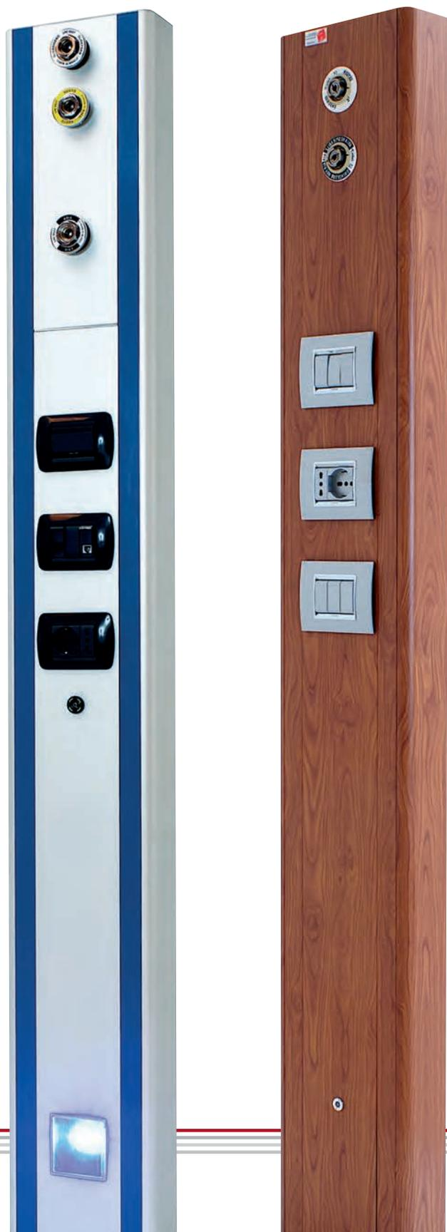
Trave testaletto realizzata con un profilo in estruso di alluminio nel quale sono predisposti vari percorsi ben separati tra loro per il passaggio di conduttori elettrici, di segnalazione, di allarmi e nel quale trovano alloggio anche i componenti per gas medicinali, separati dai componenti elettrici.
